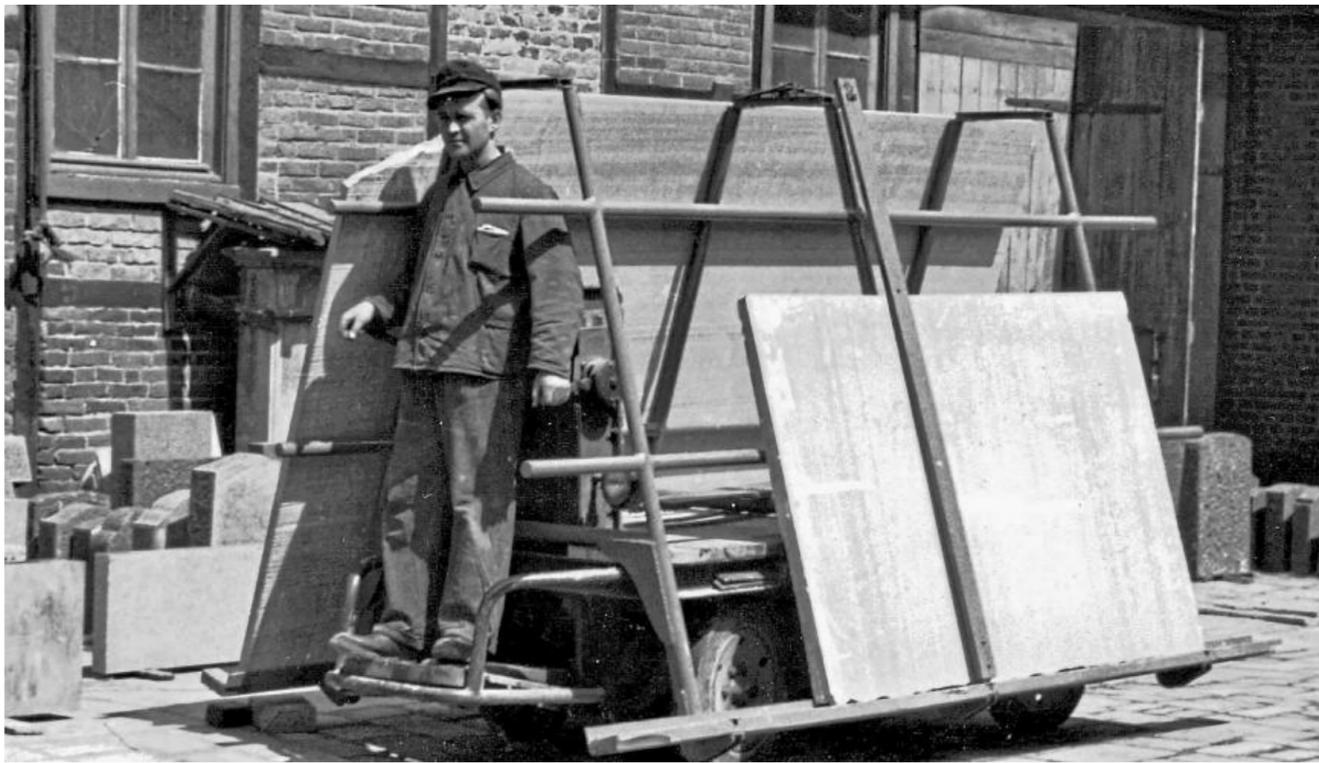
Bei der Firma Dassel setzte man früh auf alternative Energien. Ein Beispiel war der „Tummelwagen“ mit Elektroantrieb.
